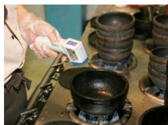
調理時に石鍋の温度を非接触温度計で確認し、商品の品質を安定させている。
